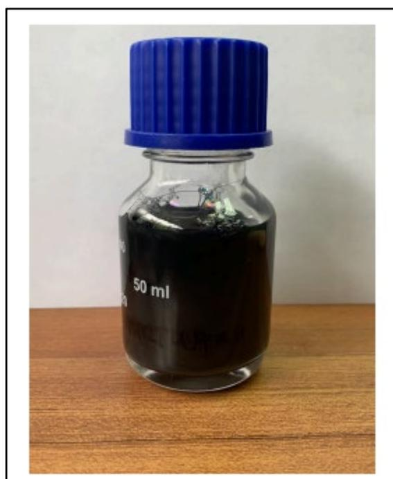
**Рис 3.3** фотография синтезированного графенового нанофлюида. [126]
