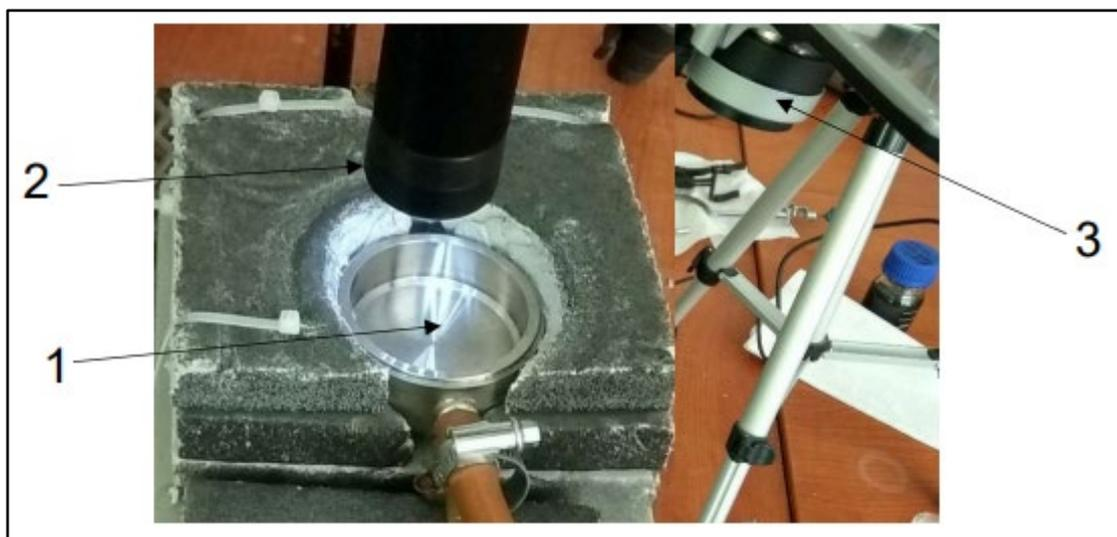
**Рис 2.12** Фотография экспериментальной установки: 1 — теплоизолированная чаша, соединенная с жидкостным термостатом; 2 — видеомикроскоп UCMOS05100KPA; 3 — тепловизионная камера FLIR X6400sc/.
