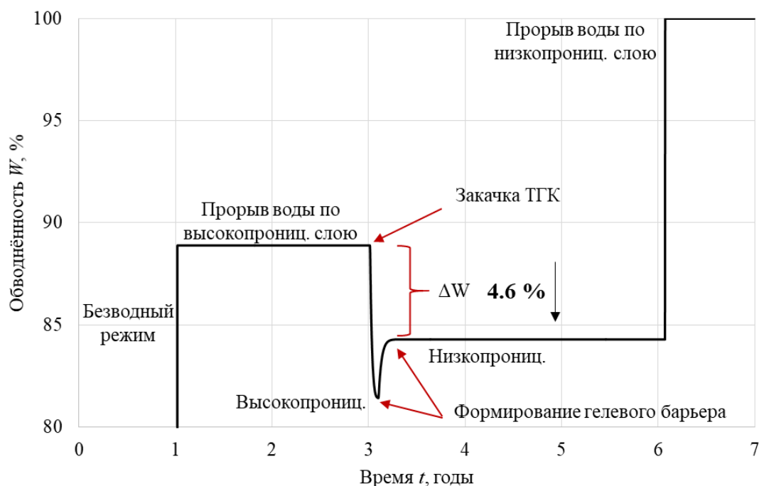
Рисунок 3.9 – Расчётная динамика обводнённости за весь период разработки
