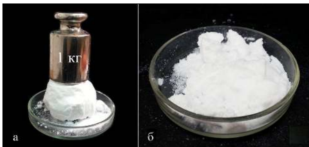
Рис. 7. Образцы гидрата метана, полученные в “сухой воде” с содержанием R202 5 мас. % (а) и 15 мас. % (б), сразу после извлечения из реактора. Температура -5^{\circ}\text{C} .
