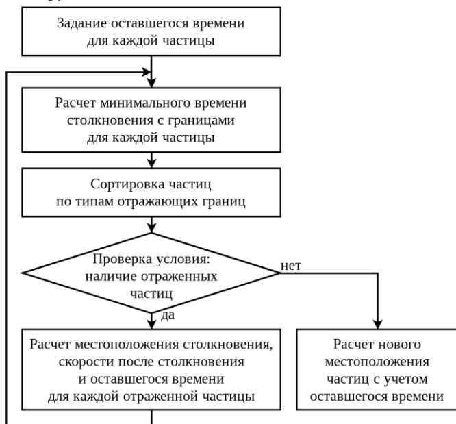
Рисунок 3. Схема расчета траектории движения частиц с учетом их возможного взаимодействия с подвижными границами
