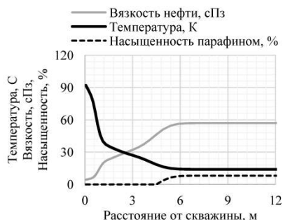
Рис. 16. Снижение вязкости нефти и очистка призабойной зоны пласта после обработки
