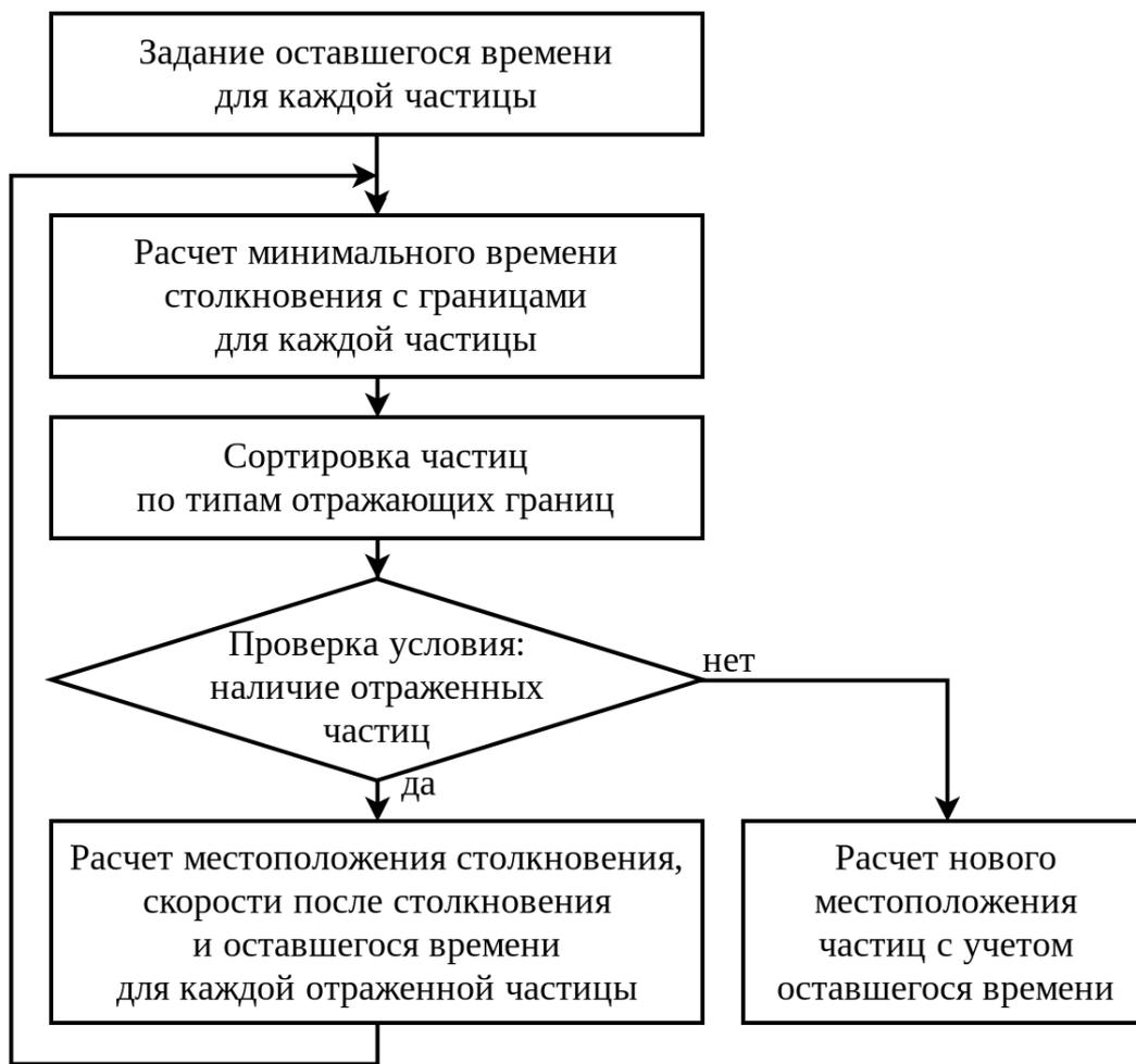
Рисунок 3.3 — Схема расчета траектории движения частиц с учетом их возможного взаимодействия с подвижными границами
