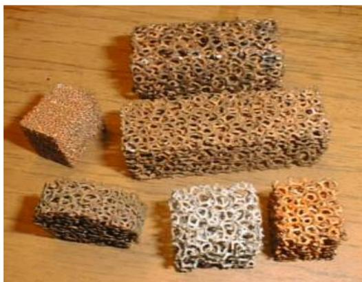
Рисунок 1.4. [70] Металлические образцы различной пористости высокопористого ячеистого материала
