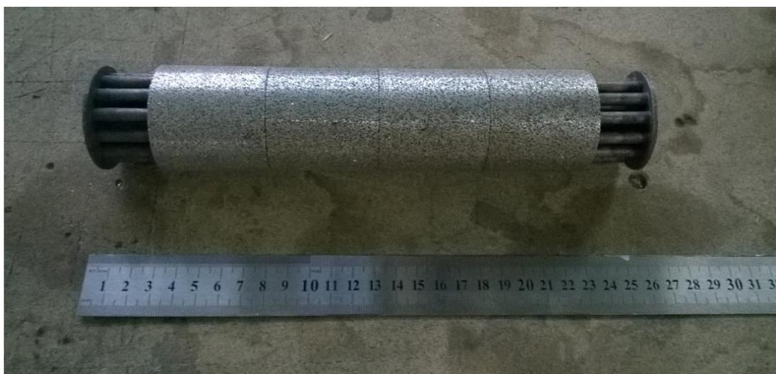
Рисунок 2.4. Внутренняя часть теплообменного аппарата из алюминия с пористым наполнением
