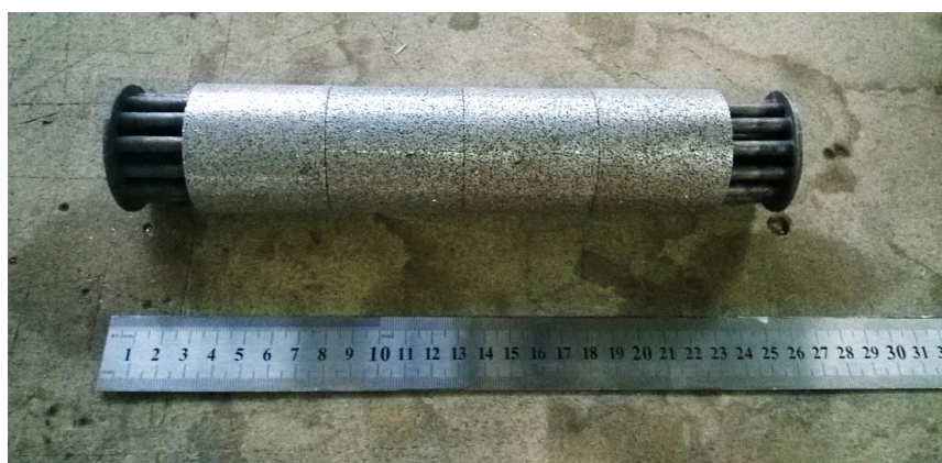
Рисунок 3. Внутренняя часть теплообменного аппарата из алюминия с пористым наполнением
