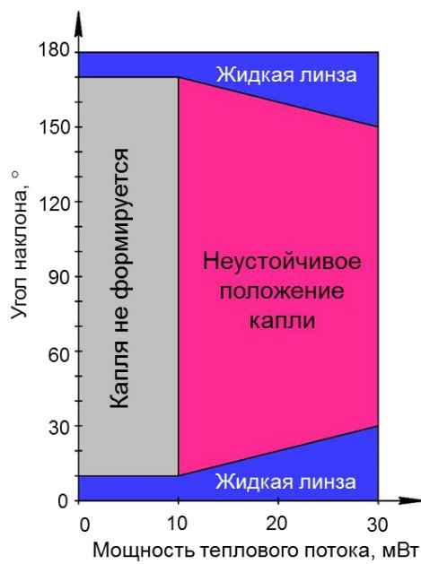
Рисунок 23 – Диаграмма устойчивости линзы на основе концентрационно-капиллярной конвекции.
