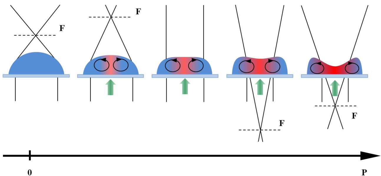
Рисунок 18 – Схема работы жидкостной линзы на основе термокапиллярной конвекции.
