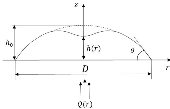
Рисунок 5 – Постановка задачи при моделировании термокапиллярной деформации поверхности капли.
