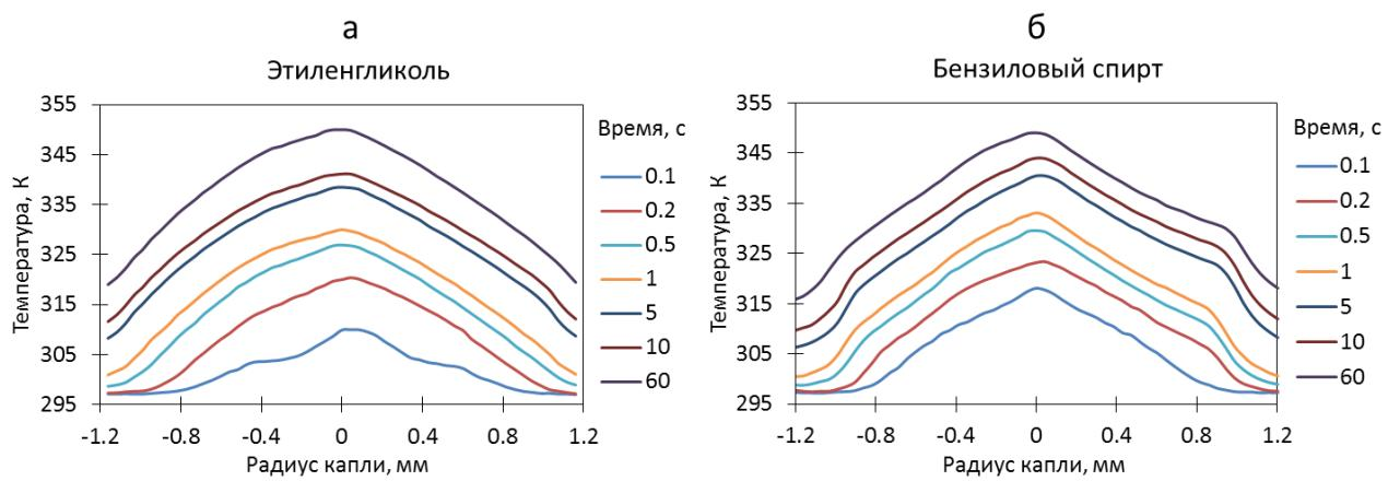
Рисунок 2 – Распределение температуры в капле: а) бензиловый спирт; б) этиленгликоль.
