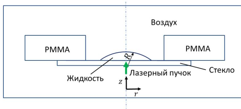
Рисунок 8 – Постановка задачи при моделировании в COMSOL Multiphysics.
