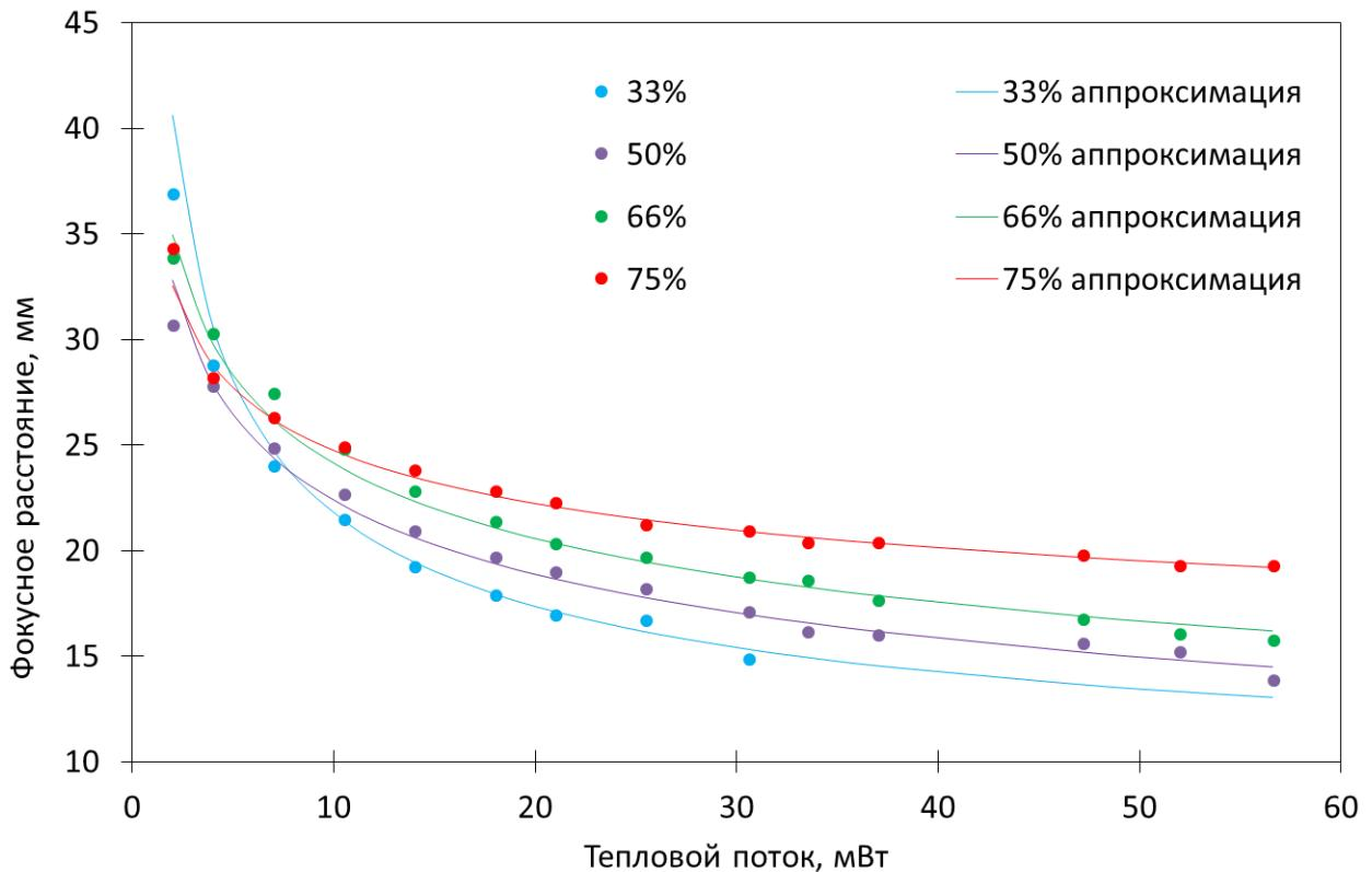
Рисунок 15 – Зависимость фокусного расстояния от теплового потока для различных концентраций этиленгликоля.
