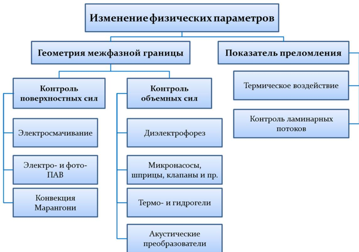
Рисунок 17 – Классификация существующих жидкых линз.
