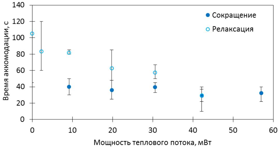
Рисунок 16 – Время перестройки фокусного расстояния поверхности при сокращении и растекании (релаксации) капли.
