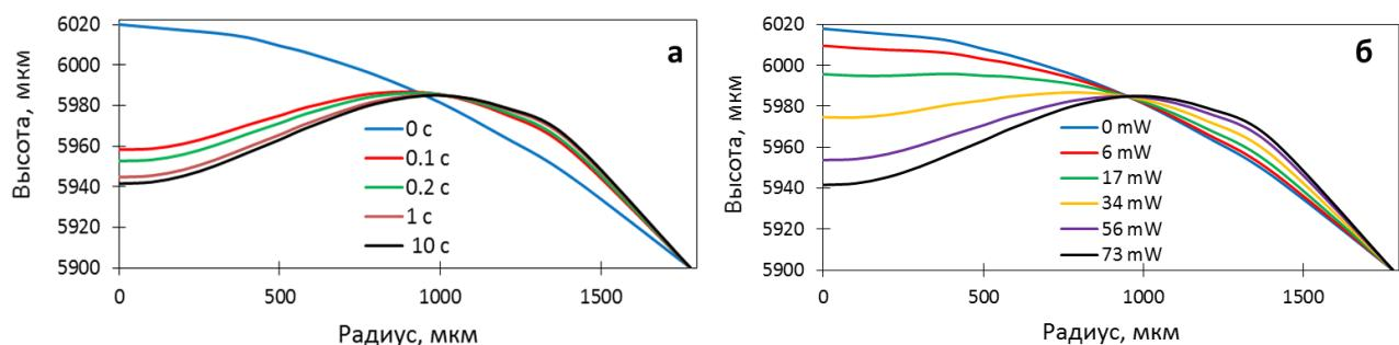
Рисунок 11 – Эволюция профиля поверхности капли при 34 мВт мощности (а) и профиль поверхности капли при различных мощностях (б).
