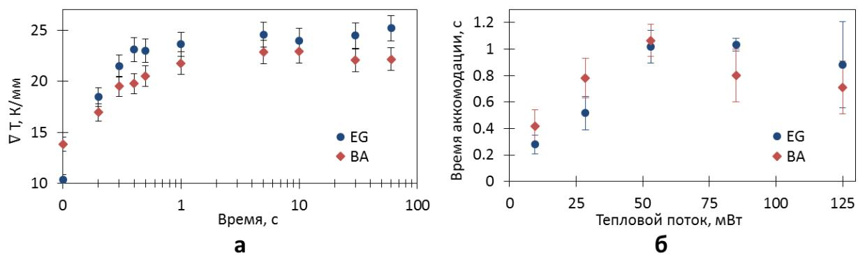
Рисунок 3 – Время стабилизации градиента температуры в капле при 125 мВт (а) и время стабилизации поверхности при различных мощностях теплового потока (б).
