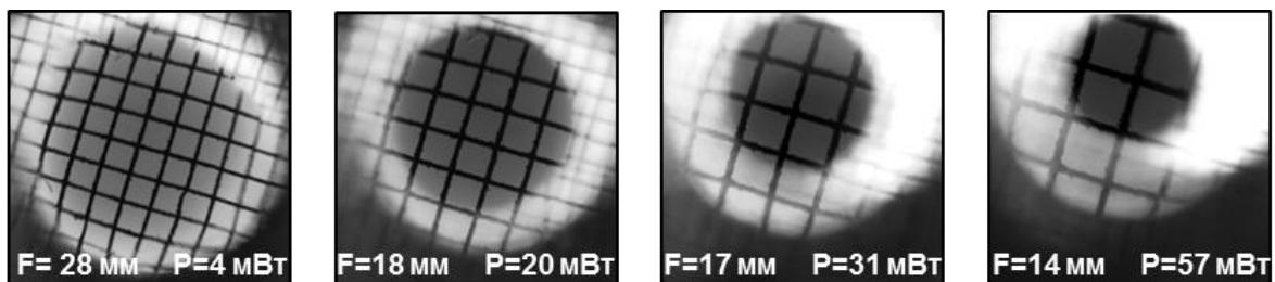
Рисунок 20 – Изображения, полученные с помощью концентрационно-капиллярной линзы.
