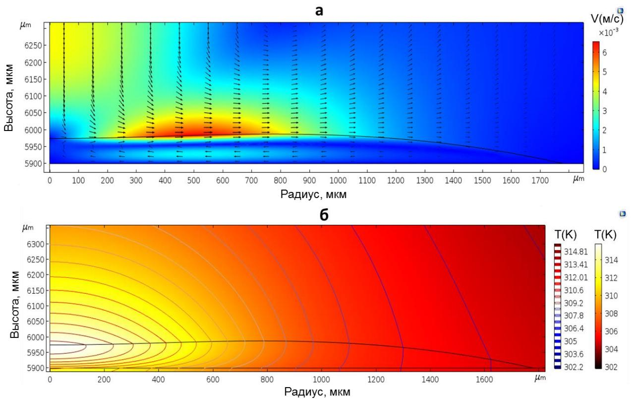
Рисунок 9 – Поле скоростей (а) и поле температур (б) в сидячей капле бензилового спирта при мощности теплового потока 34
