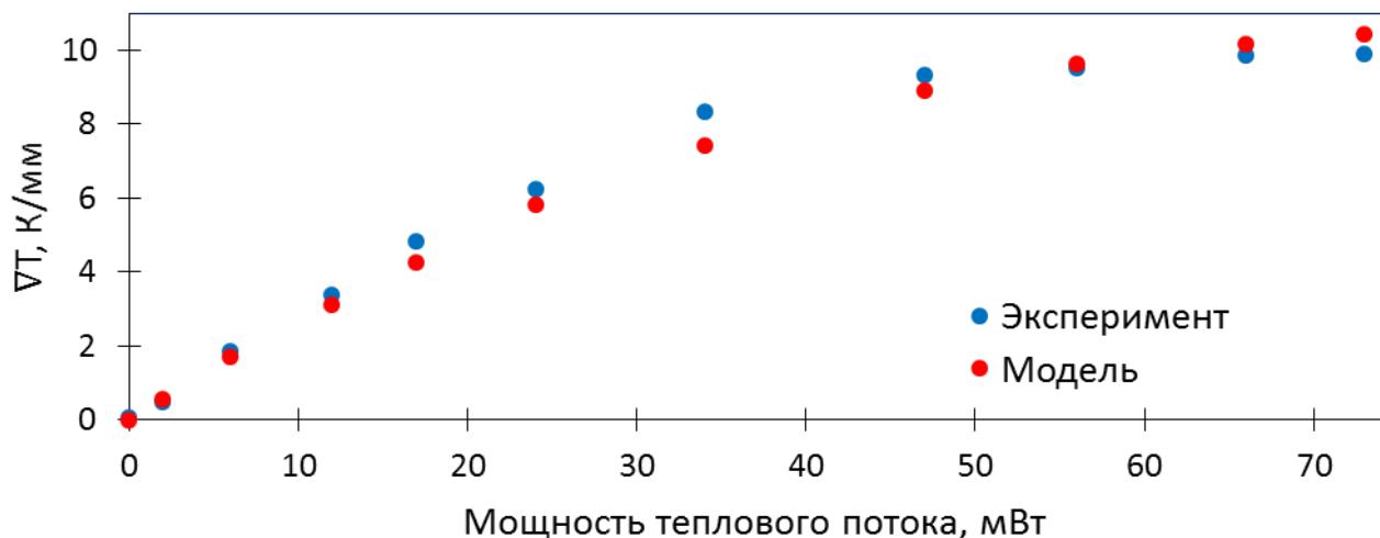
Рисунок 10 – Зависимость градиента температуры на поверхности капли от мощности теплового потока.
