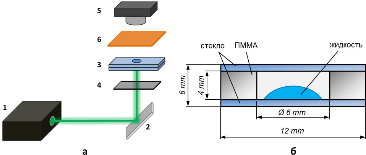
Рисунок 1 – Схема экспериментальной установки (а) и ячейки с каплей жидкости (б)
