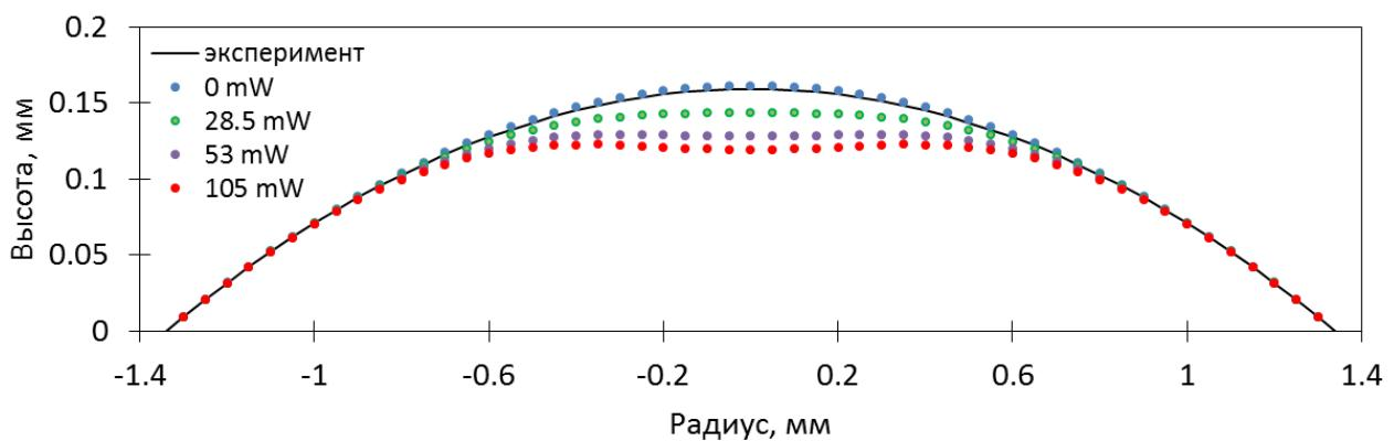
Рисунок 6 – Кривая поверхности капли, деформированная термокапиллярной конвекцией.
