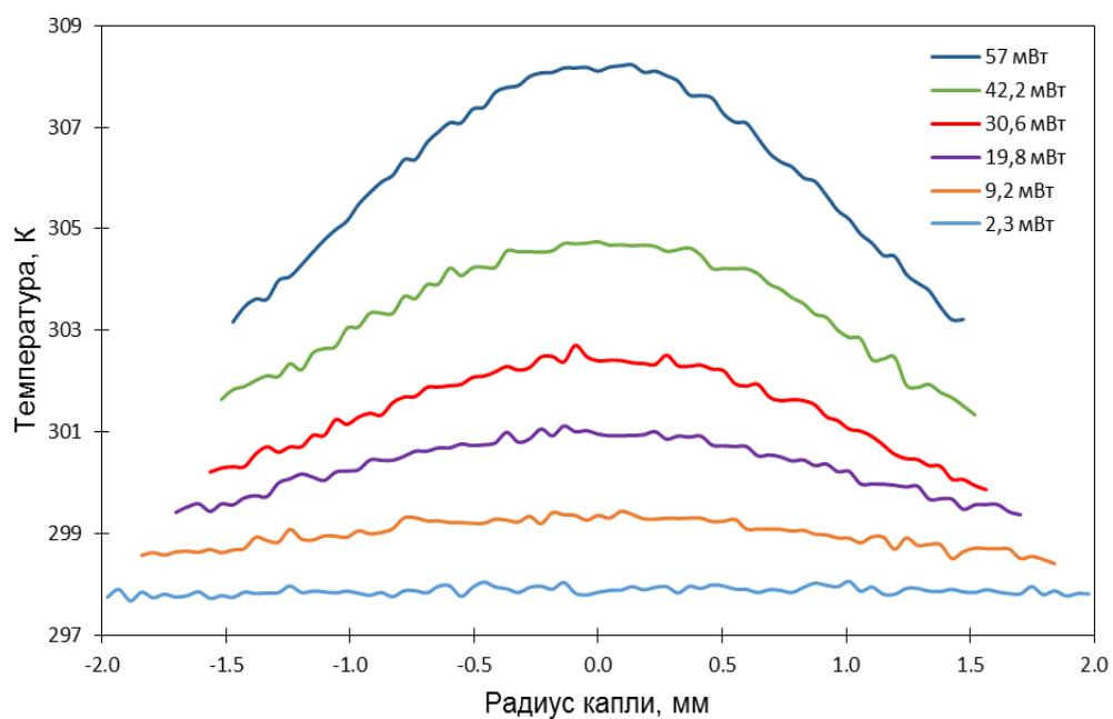
Рисунок 13 – Распределение температуры в капле бинарного раствора при различной мощности теплового потока.
