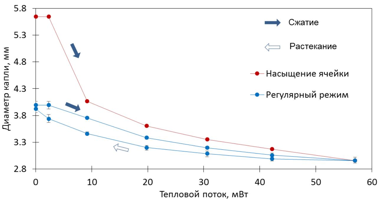
Рисунок 14 – Изменение диаметра капли при циклическом изменении мощности.
