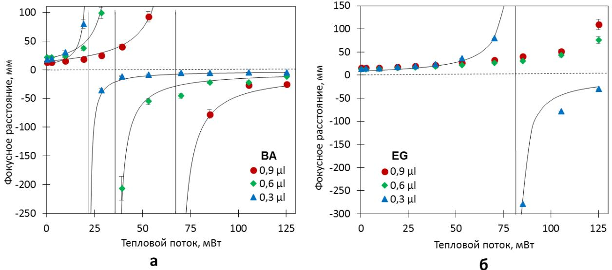
Рисунок 4 – Зависимость фокусного расстояния жидкокапельной линзы на основе бензилового спирта (а) и этиленгликоля (б) от мощности теплового потока.
