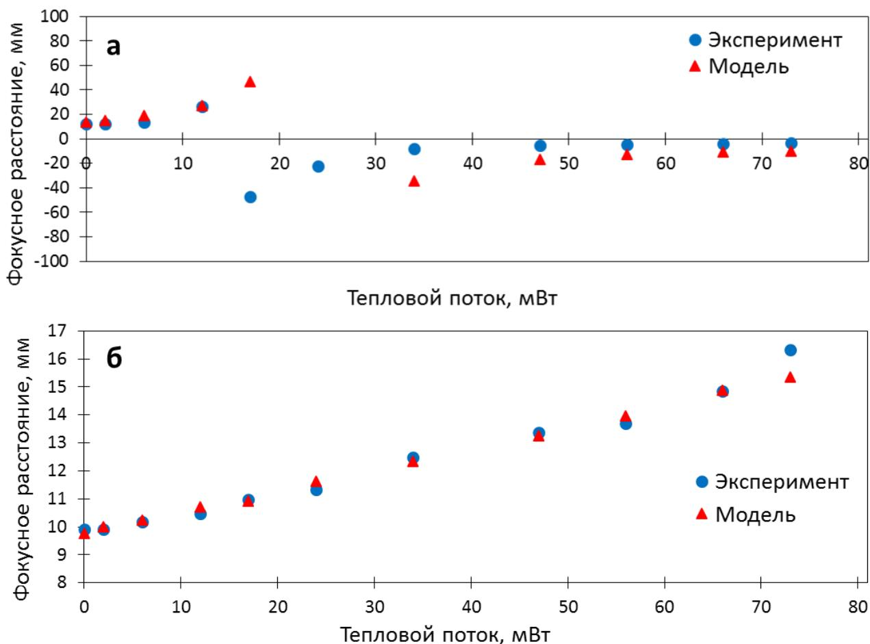
Рисунок 12 – Зависимость фокусного расстояния преломляющей поверхности капли бензилового спирта (а) и этиленгликоля (б) от мощности теплового потока.
