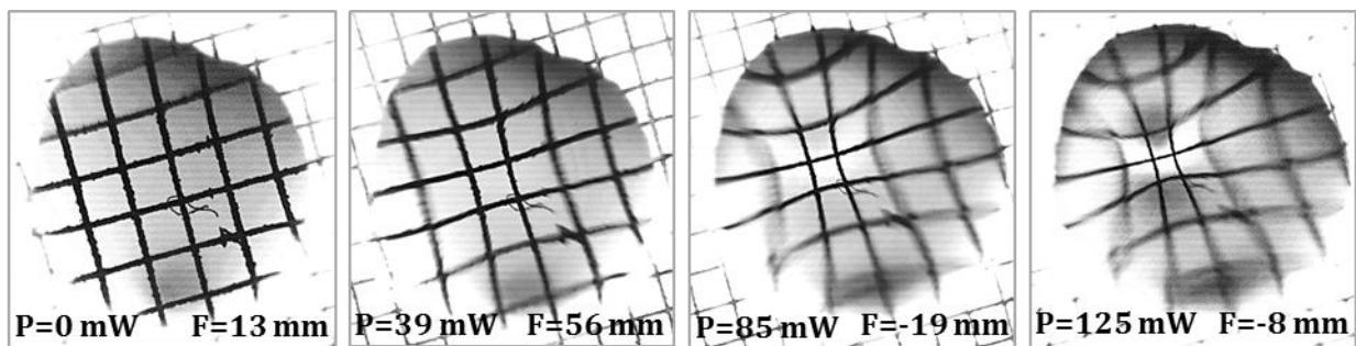
Рисунок 19 – Изображения тестового объекта, полученные с помощью линзы на основе термокапиллярного эффекта.
