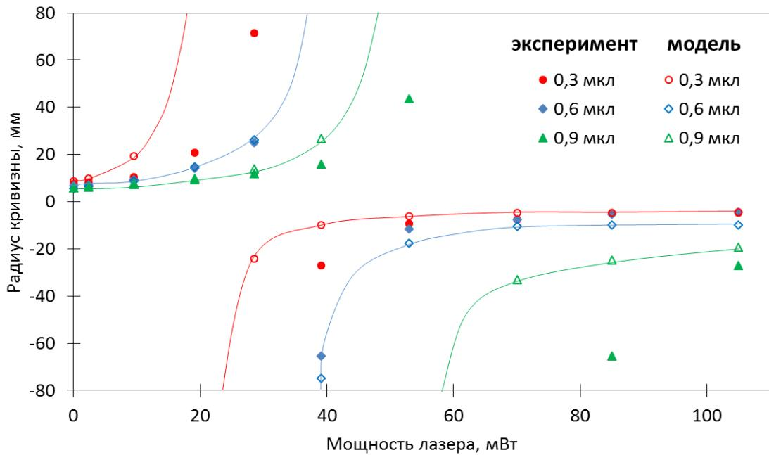
Рисунок 7 – Численная и экспериментальная зависимости радиуса кривизны от фокусного расстояния.
